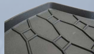
erhöhter Rand schützt Wageninnere vor Feuchtigkeit und Verunreinigungen
